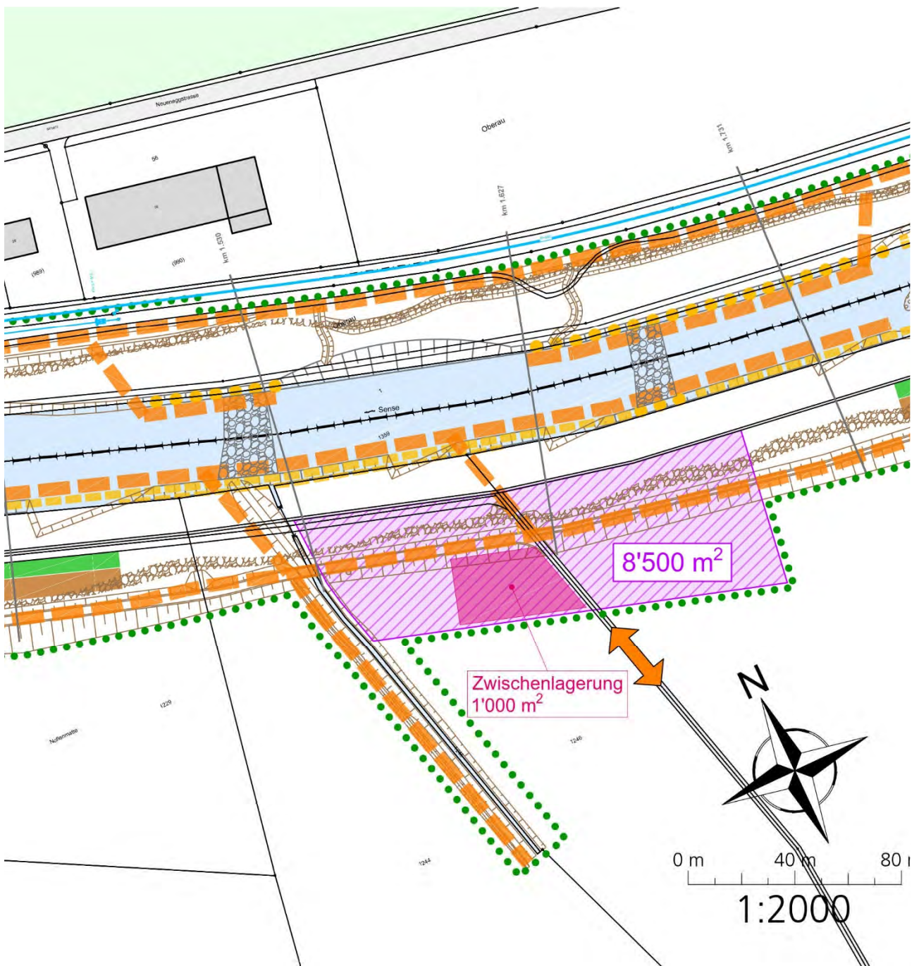
Abbildung 7.2 Installationsplatz Noflenmatte mit Zwischenlagerplatz (schematisch)
